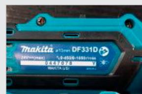
**Maschinen & Akkus:** Achten Sie auf die **Typenschilder** und vergleichen Sie diese mit dem Makita Original. Achten Sie auf das Makita Logo und vollständige technische Angaben, bspw. auf dem Gehäuseboden des Akkus (u.a. Spannung in V, Kapazität in Ah).
