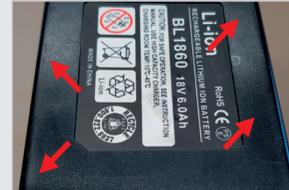
**Die vier kleinen Öffnungen** an der Gehäuseunterseite dienen der Feuchtigkeitsableitung und sind bei allen aktuellen 18 V LXT-Akkus vorhanden.
