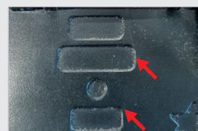
Bei Nachbau-Akkus fehlen häufig die aufgedruckte **Seriennummer**, das **Material-Kurzzeichen** sowie weitere Details.
