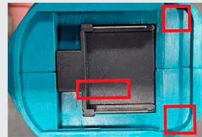
Die **Akku-Aufnahme** an der Maschine sind bei Nachbauten häufig anders aufgebaut und minderwertig verarbeitet. Vergleichen Sie diese mit Original Makita Maschinen.
