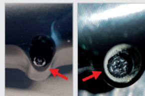
Original-Akkus sind mit **T-Schrauben** mit Sicherheitspin ausgestattet, von denen eine mit einer **weißen Abdeckung** versehen ist.
