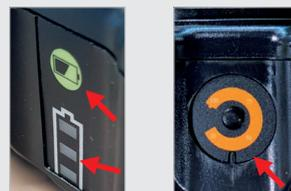
Beim Original leuchten **vier vertikale rote LED-Balken** als **Kapazitätsanzeige**, die nach dem Drücken des Buttons ca. 3 Sek. nachleuchten und alle zeitgleich ausgehen.
