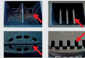
**Die Lüftungsöffnungen** sind bei Nachbauten häufig anders aufgebaut.
