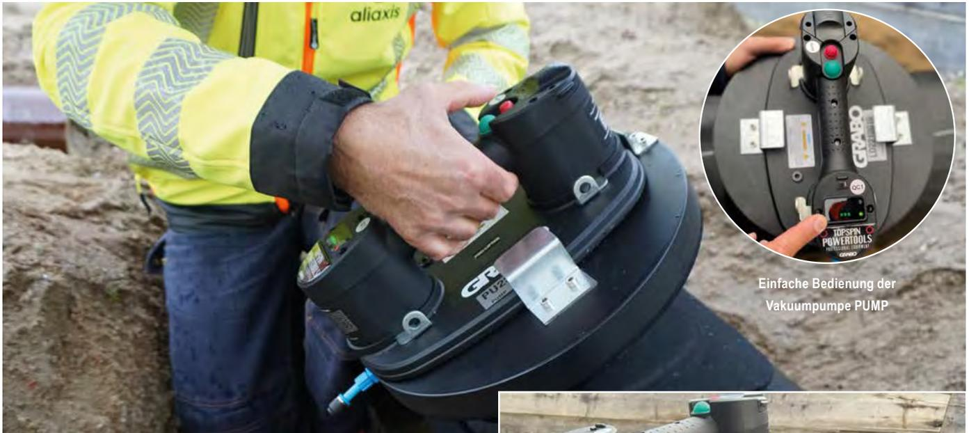
Einfache Bedienung der Vakuumpumpe PUMP
