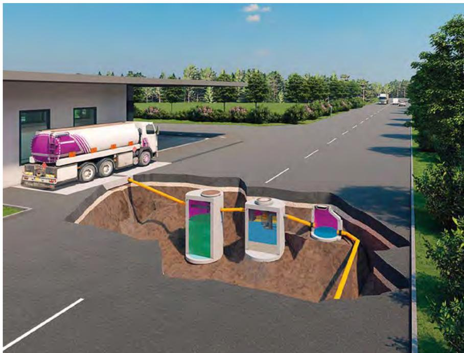
Die Auffangwanne unterhalb des LKW fängt Regenwasser und havarierte Flüssigkeiten beim Ab- oder Umfüllprozess auf und leitet diese durch oder in den FUCHS Presidio, den FUCHS Abscheider und den Probennahmeschacht
