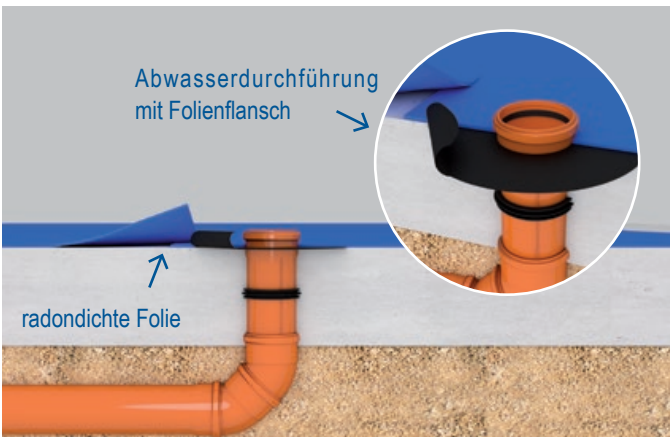
Sichere Einbindung der radondichten Folie über Folienflansch.
