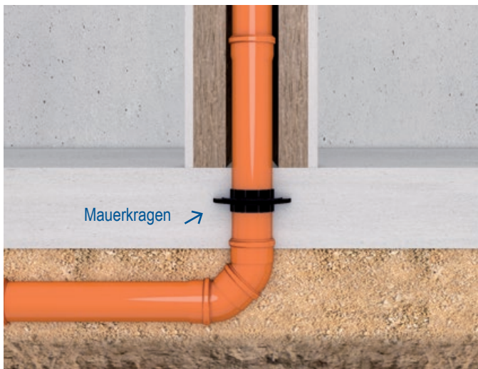
Sichere Abdichtung der Abwasserleitung mit einem Mauerkragen.
